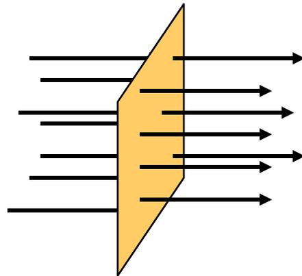
Una superficie que estuviera colocada en un campo eléctrico  $\vec{E}$  sería atravesada por las líneas de campo.
