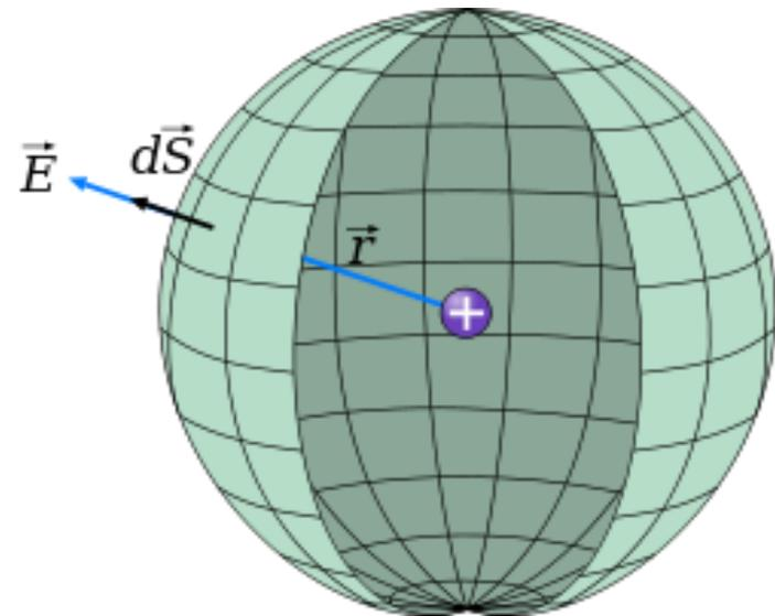
En todos los puntos de la superficie de la esfera de radio R el campo eléctrico creado por una carga puntual +Q tendrá el valor
