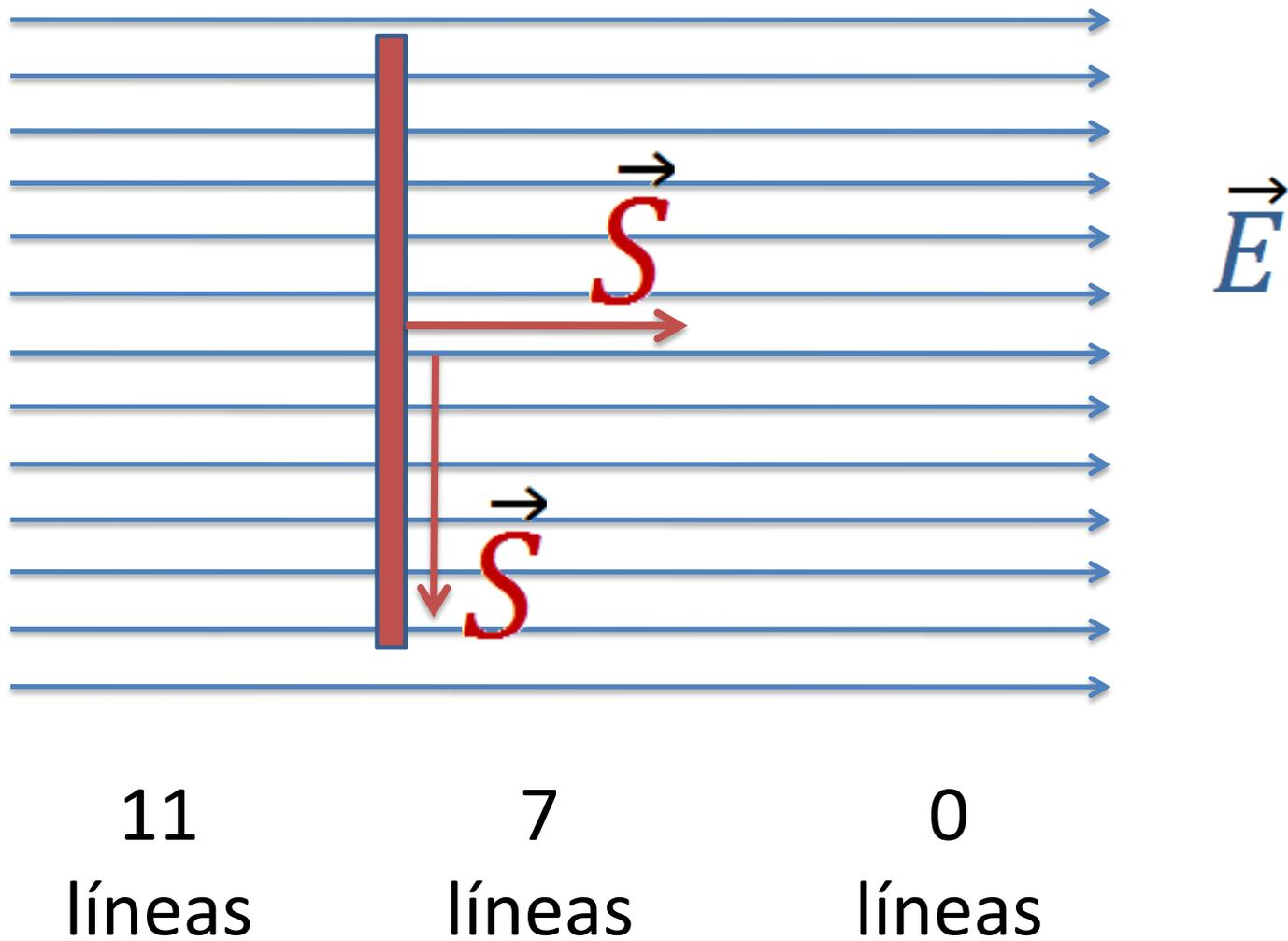
Como el campo eléctrico puede ser diferente en cada punto de una superficie, en la práctica se trabaja con elementos de superficie  $d\vec{S}$ , de forma que el flujo correspondiente a cada uno de estos elementos de superficie es:
