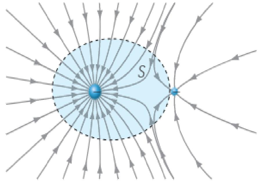
Superficie cerrada con una carga en su interior. El flujo neto es el debido a esa carga, pues las líneas de campo que proceden de la carga externa entran y salen de la superficie cerrada.
