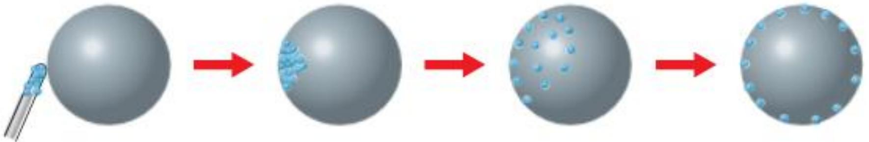
Un conductor cargado en equilibrio se comporta como una esfera hueca que solo tiene carga en su superficie más exterior.
