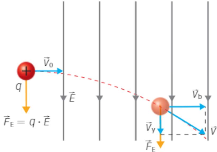
La trayectoria de un cuerpo cargado que penetra en un campo eléctrico perpendicular a su dirección de movimiento es parabólica.
